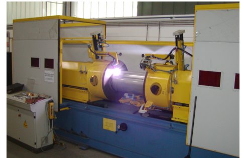
Automatsko zavarivanje bojlera od nehrđajućeg čelika
