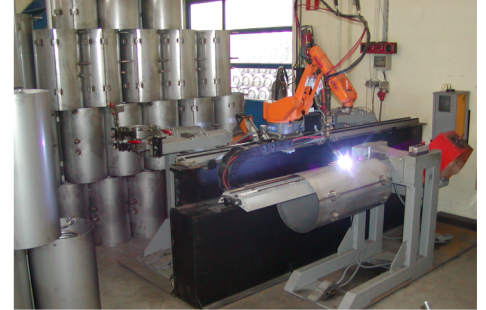
Robotsko zavarivanje bojlera od nehrđajućeg čelika
